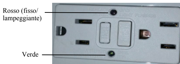
Figura 3. Luci della presa NEMA 5-15
